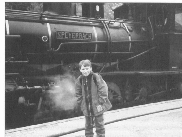
Dampfloz „Speyerbach“, Baujahr: 1904, Gewicht: 65 t, Kohlen-Vorrat: 5 t, Leistung 420 PS, Höchstgeschw. 40 km/h
